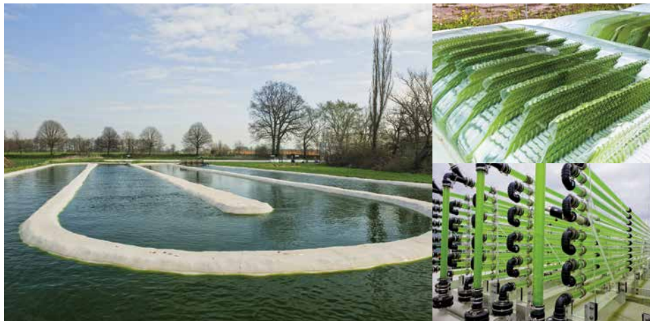
Kuva 8: Leväkasvatusta avoimessa kilparata-altaassa (vasemmalla), suljetuissa levyissä (keskellä) ja putkimallisessa fotobioreaktorissa (oikealla); lähde: Hans Wolkers
